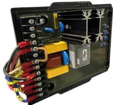
Genauigkeit Automatischer Spannungsregler mit dreiphasiger Messung (AVR) +-1%.
